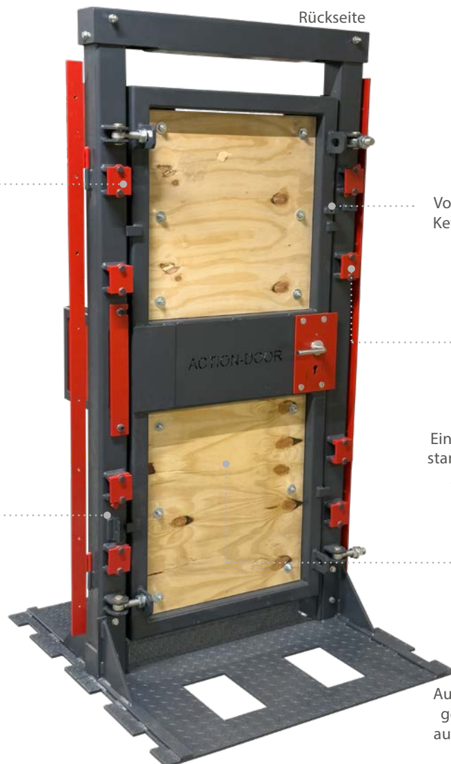
Schiene zum Anschrauben einer Platte zur Hauswand-/Treppensimulation.
