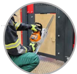
Austauschbare Holzplatten für die gewaltsame Öffnung. Alternativ auch Sandwichelemente möglich.
