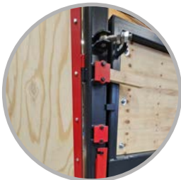
Schiene zum Anschrauben einer Platte zur Hauswand-/Treppensimulation.
